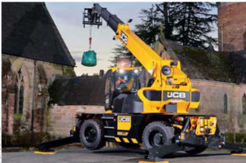
El JCB RTH 558-210R, un manipulador telescópico giratorio diseñado para responder a las exigencias de la minería moderna.
